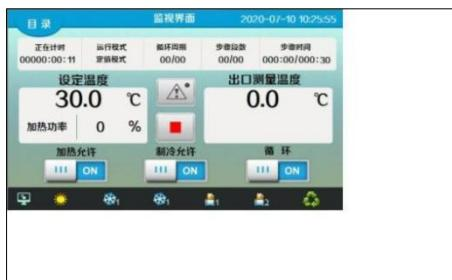
在【监视界面】用户可以查看要控制的数据，运行的时间进度，系统的各项控制输出状态，控制系统的运行，温度加热、制冷、循环。
