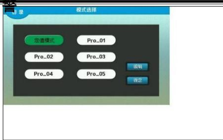
系统有定值模式，程序模式 01，程序模式 02，程序模式 03，程序模式 04，程序模式 05 共 6 种运行控制模式；用户可以自己设定编辑每种运行模式（根据【系统设置】、【温度参数】中的“温度慢定上下限”决定设定范围）、加热允许、制冷允许；
