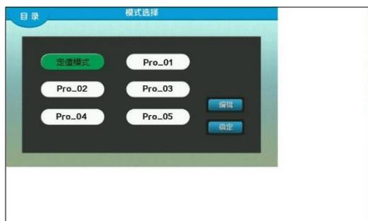
系统有定值模式，程序模式 01，程序模式 02，程序模式 03，程序模式 04，程序模式 05 共 6 种运行控制模式；用户可以自己设定每种运行模式中的运行周期 (0~99)、段数 (1~30)，和“温度下限”决定设定范围)、加热允许、制冷允许；
