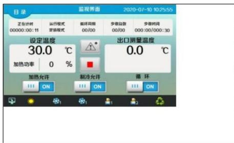
在【监视界面】用户可以查看要控制的数据，运行的时间系统的各项控制输出状态，控制系统的运行，温度加热、制冷、循环
